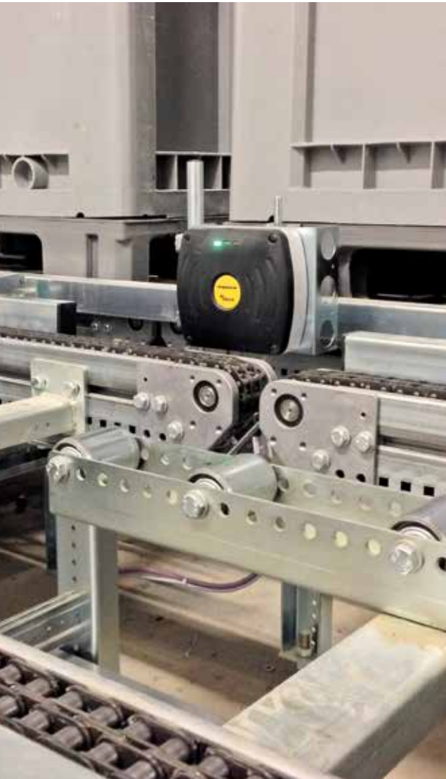
设备上的LED灯直接指示读/写头状态
