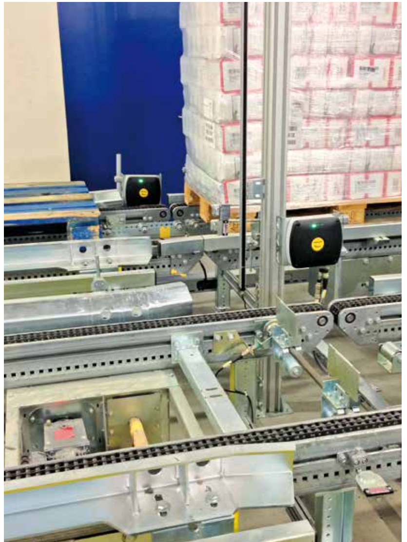
邻区干扰消除：读/写头都只读取其正前方托盘上的载码体信息
