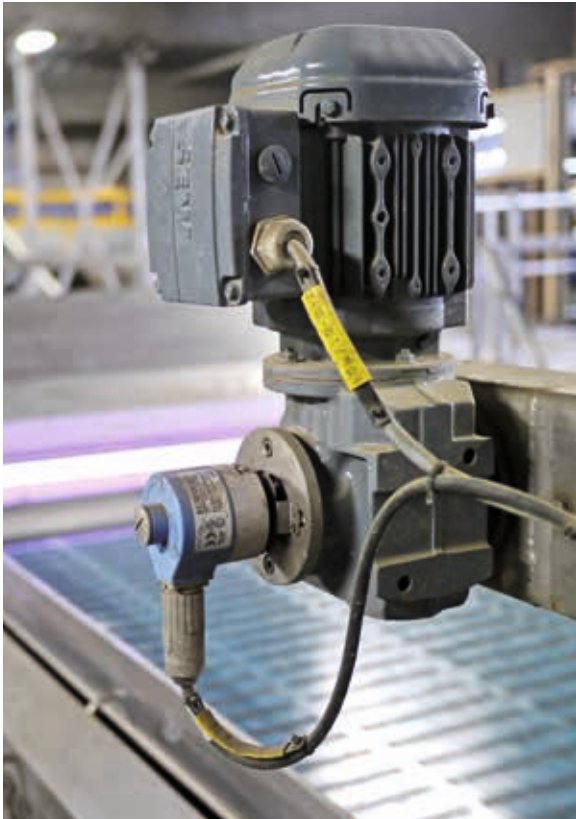
先前的解决方案：该编码器的弹性安装 易受机械故障和磨损影响
