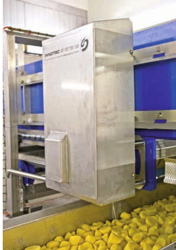
双重防护：不锈钢防护罩在运转过程中保护整个电机和编码器
