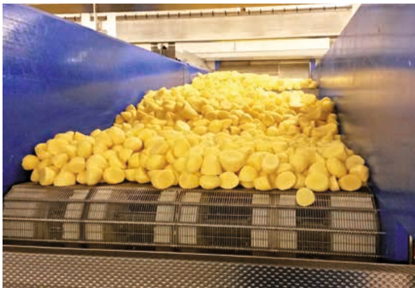
缓冲输送机：输送带上最多可缓冲500公斤马铃薯
