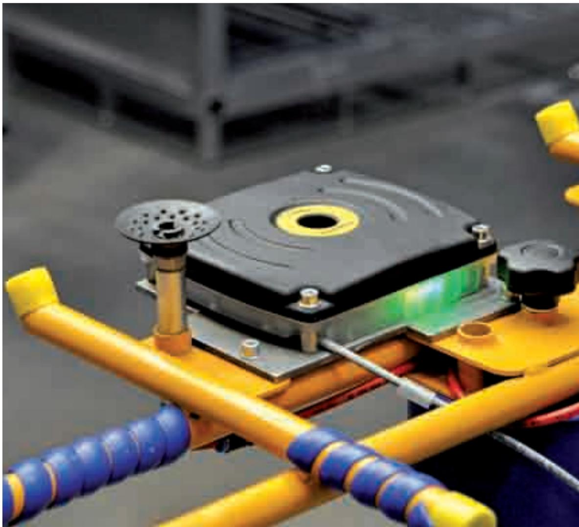
但是这也使系统集成面临更大的挑战。一般情况下，读写头检测到载码体，然后通过软件读取和管理，这样就可以在整个生产和物流过程中实现对保险杠的追踪：在喷漆之前，读写头检测保险杠在滑轨内的位置，并将位置信息传输到中间件，由此追踪生产质量；在喷漆之后，整个喷漆车间的数据也被自动链接到保险杠。
