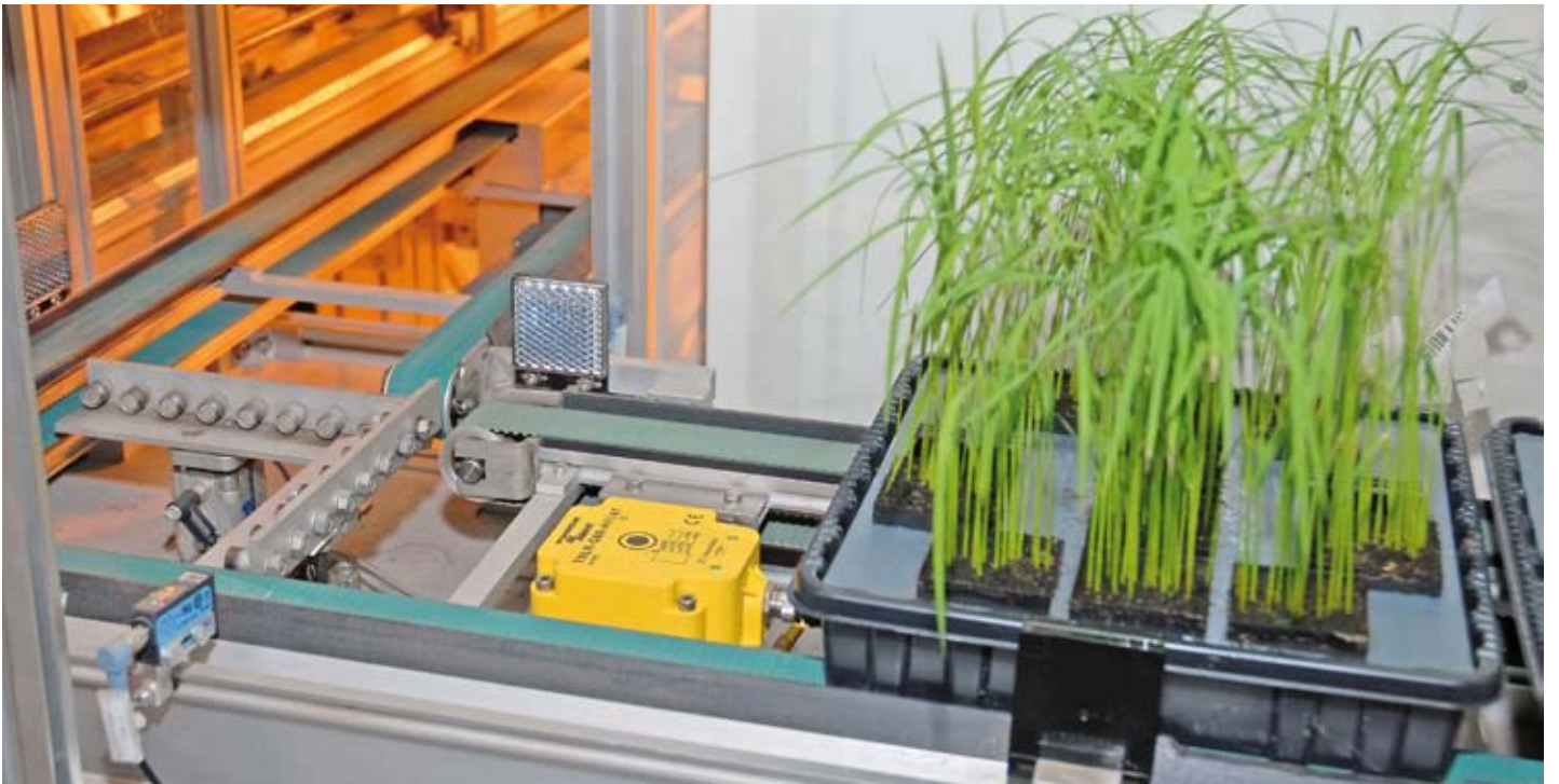
在植物槽离开喷洒单元后，所有有关数据都被写在植物槽中间的RFID标签上
