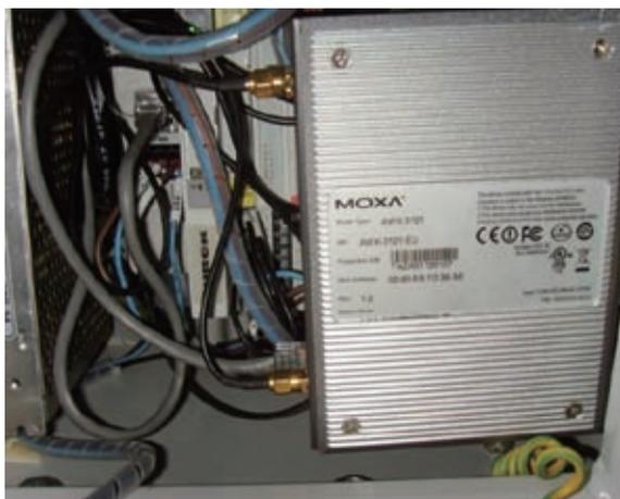
图尔克PG-EN网关通过连接无线热点，实现无线网络数据通讯
