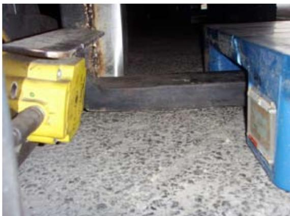
图尔克RFID读写头被安装在叉车前端，从而更靠近托盘上的载码体，使读取效果得到大大地改善
