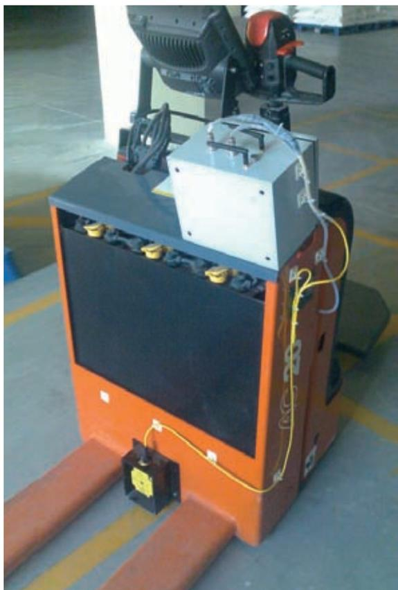
图尔克RFID读写头形状与接近开关类似，安装灵活方便
