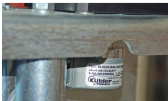
Pro Pack公司的新机器上还使用了编码器
