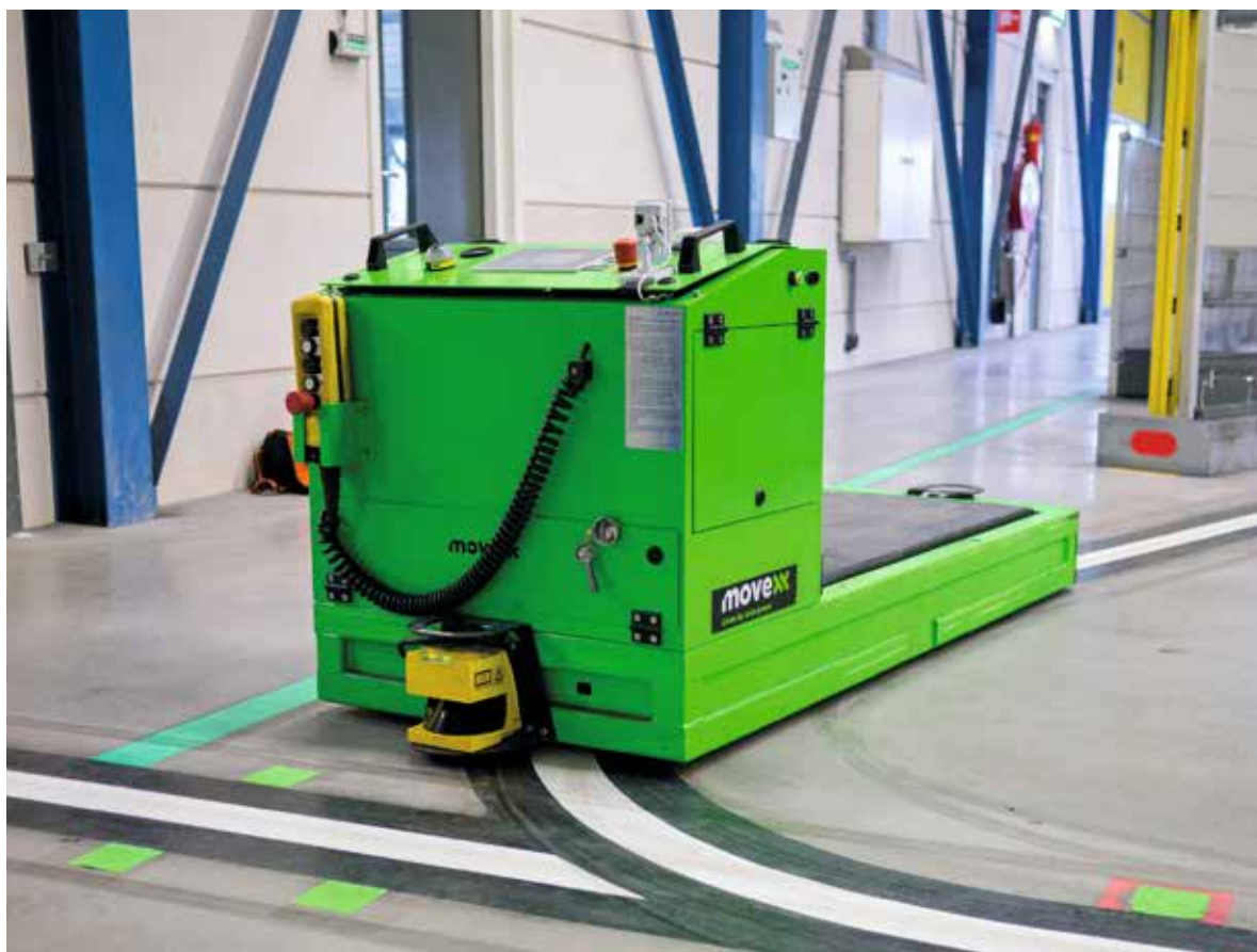
为AGV提供位置信息的RFID标签被嵌入在交叉点和其他关键点的地面中
