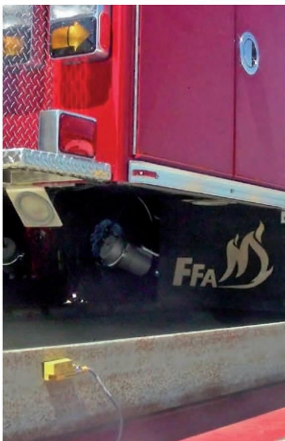
图尔克倾角传感器测量倾斜平台的倾斜角度
