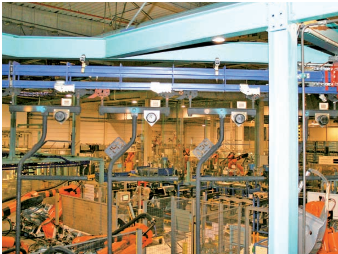
时至今日，运输系统一般采用RFID数据载体进行识别，如此例中供应商Tower Automotive的运输吊架
