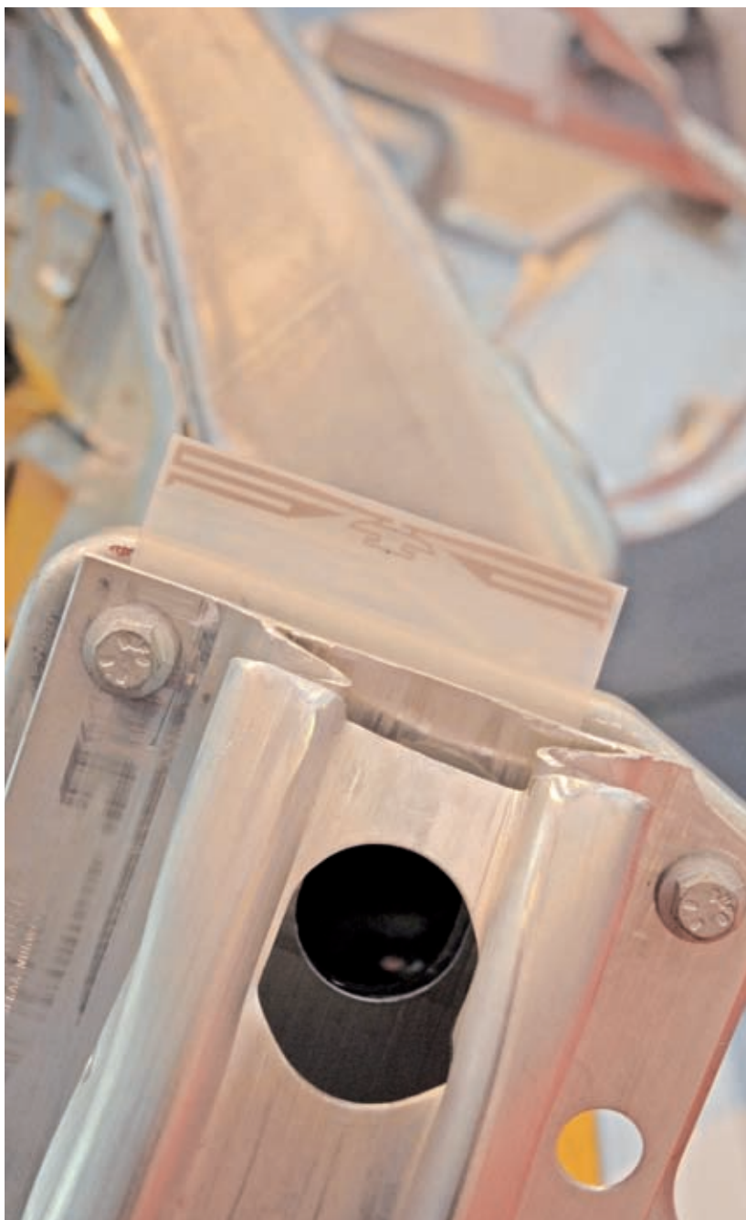
在根特沃尔沃，从焊接开始时就直接在车身大梁上安装一个坚固的塑料标签
