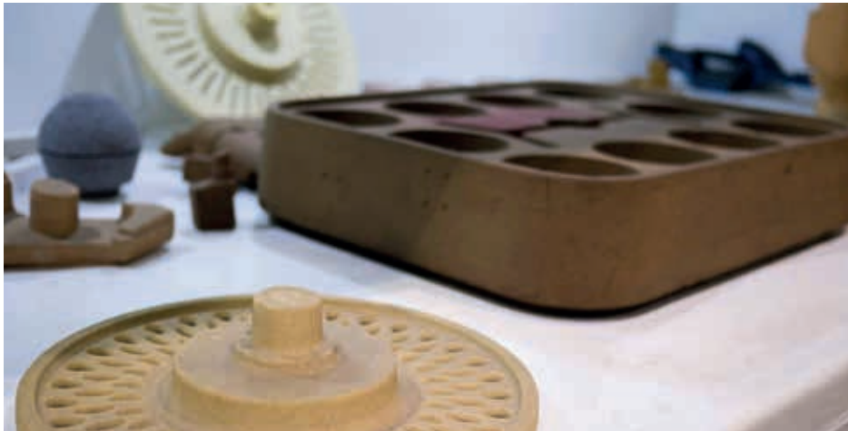
Laempe Mössner Sinto 可生产多种用于金属铸造的砂芯。
