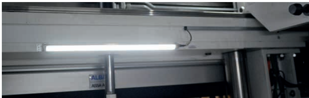
来自图尔克的WLS-28可调光LED灯可通过标准M12连接器连接
