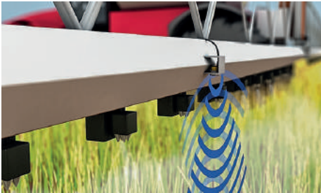
图尔克带PTFE涂层的超声波传感器测量喷嘴与农田或作物间的距离，并且耐受常用的作物杀虫剂
