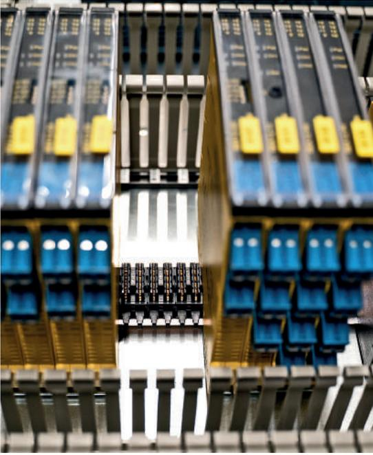
电桥系统通过DIN导轨连接
