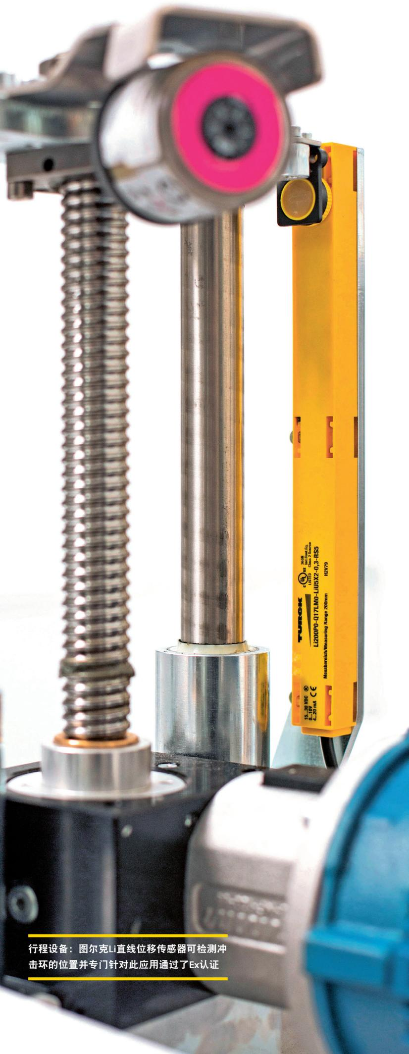
行程设备：图尔克Li直线位移传感器可检测冲击环的位置并专门针对此应用通过了Ex认证
