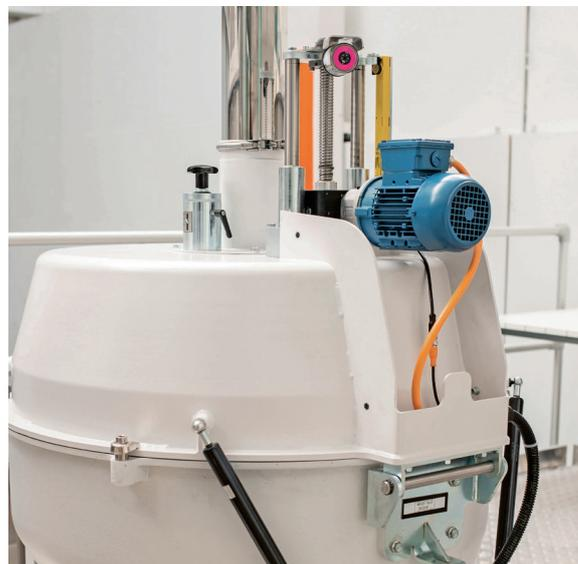
Bühler AG研磨解决方案技术中心的MHSA脱壳机：冲击环在脱壳过程中在外罩下方上下运动
