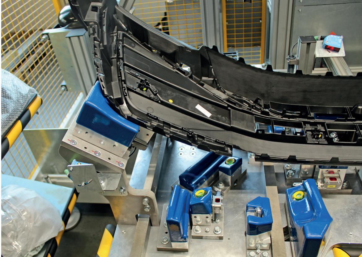
已喷漆的汽车保险杠放置在LASE装配单元上，通过超声波技术冲压用于停车传感器的安装孔
