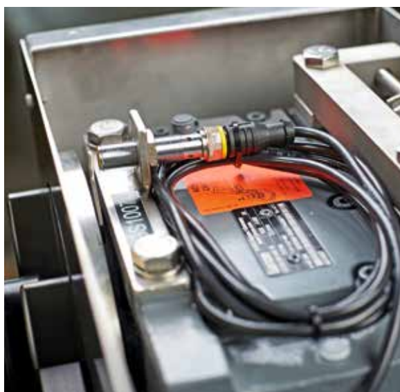
BI6U-M12-IOL6X2 IO-Link 传感器通过检测旋转单元上的凸点来确定正确的位置
