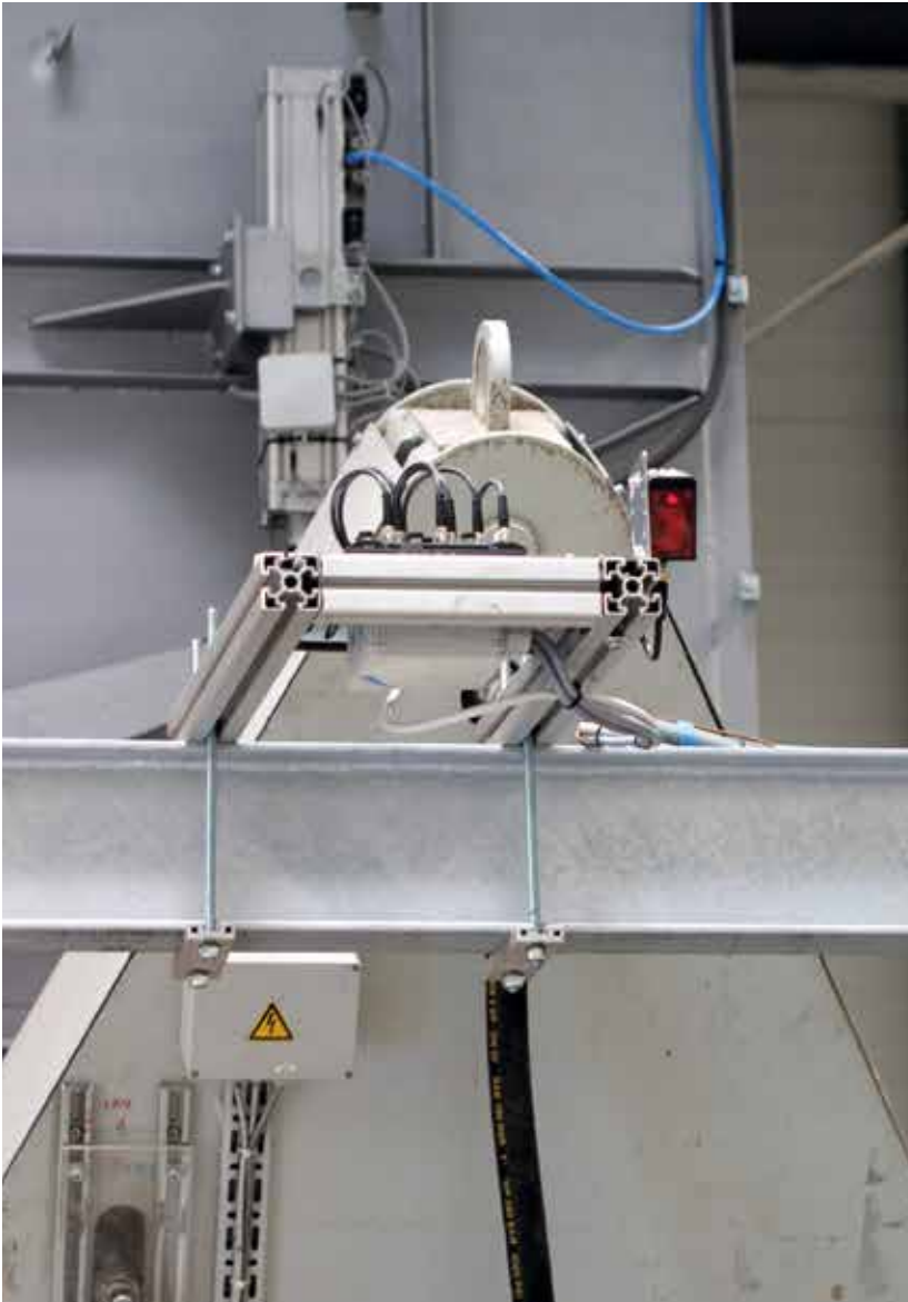
邦纳公司的LTF12激光传感器检测纸捆的输出，并在超出限值时向TBEN-S发送信号
