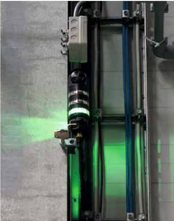
TL50C信号灯可以通过视觉和声音方式为相邻房间内的员工指示“Balemaster”的状态。
