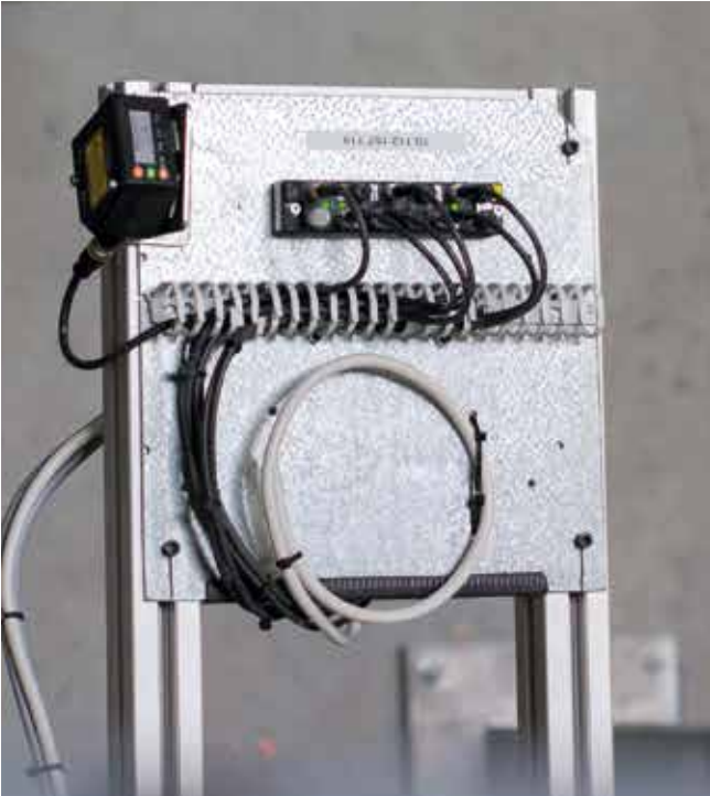
分布式智能：图尔克带ARGEE的紧凑型TBEN-S block I/O模块可以直接在现场控制应用，无需控制柜
