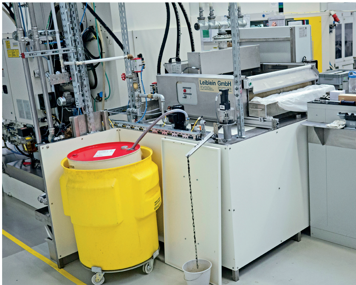
装有Robsol（RobMation的专有KSS冷却浓缩液）的桶位于处理设备的后面
