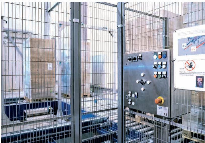
2个控制柜用于手动控制。它们包含FEN20多协议模块，可以扩展输入和输出的信号数量
