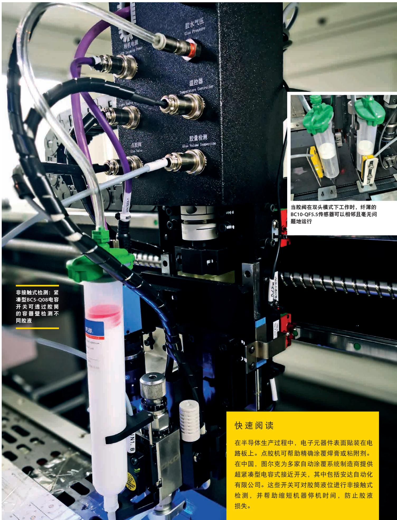
非接触式检测：紧凑型BC5-Q08电容开关可透过胶筒的容器壁检测不同胶液
