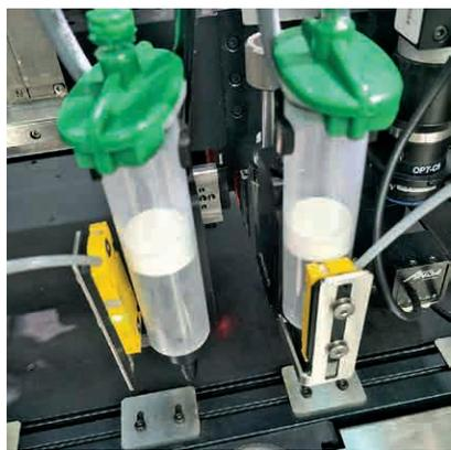
当胶阀在双头模式下工作时，纤薄的BC10-QF5.5传感器可以相邻且毫无问题地运行
