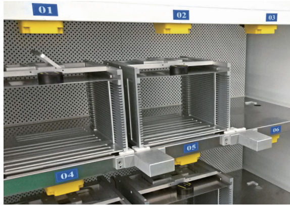
物料货架顶部的RFID高频读写头可在物料拾放期间读取晶圆载具的载码体
