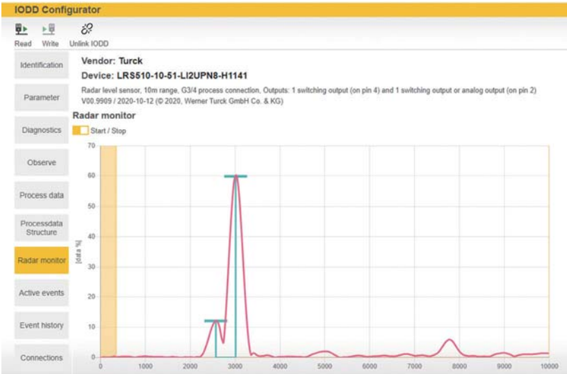
基于浏览器的图尔克雷达监视器使得用户能直观调整雷达传感器并屏蔽干扰源
