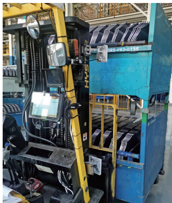
叉车上的UHF天线可识别容器ID并在WMS中更新位置；运输作业直接在监视器上显示
