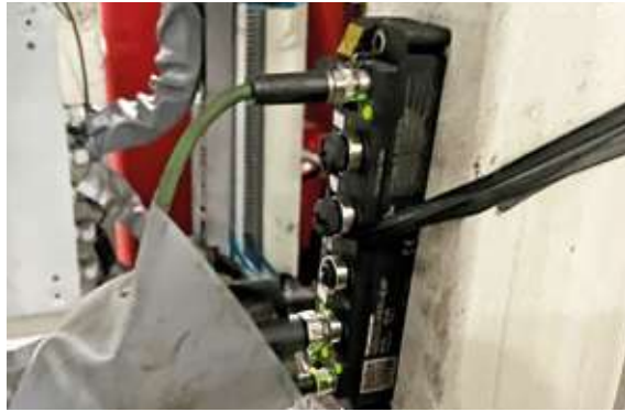
图尔克TBEN-S RFID模块具有1万6千字节的数据缓存区，性能惊人
