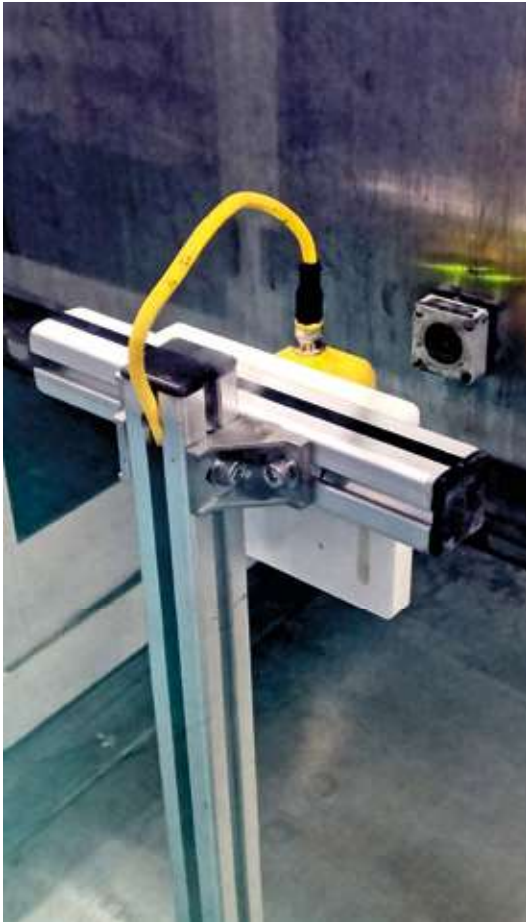
各工艺步骤工位上的HF读写头确保数据采集可靠进行
