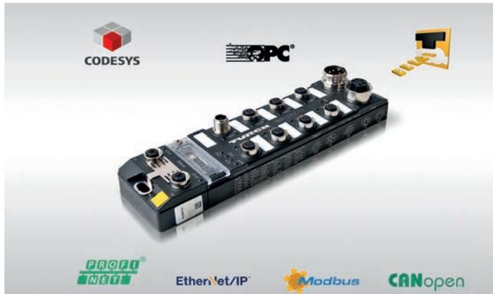
TBEN-L PLC是首款适用于工业应用的IP 67控制器，它集成了CODESYS PLC功能，可以同时实现云连接和工业以太网通信。该坚固模块支持全新的双MAC模式，可在通过其中一个端口建立与自动化网络的连接的同时，通过另一个端口建立与云端的安全连接。当不需要与云连接时，则可用于两个不同以太网协议之间的通信。例如，可以作为Profinet设备的同时又可以作为EtherNet I/P, Modbus TCP / RTU 或 CANopen主站。
