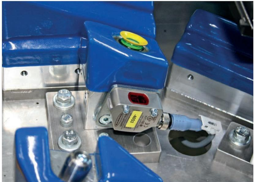
Q4X激光测距传感器能可靠且精确地测量毫米级的距离，并可分析光强度的变化
