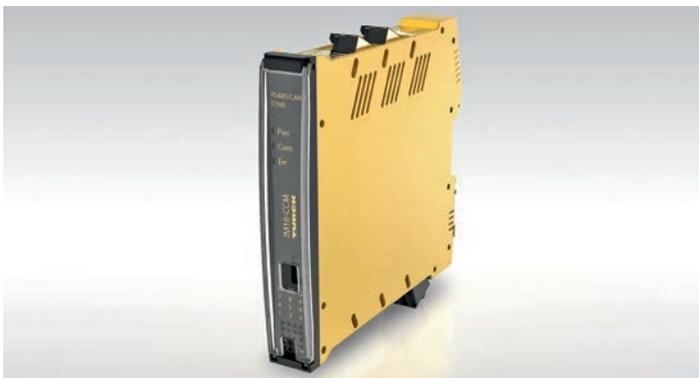
图尔克对其机柜保护模块进行了扩展，推出了IM18-CCM。该设备宽仅18mm，配备可监测温度、相对湿度和柜门距离的传感器，并可通过以太网将这些信息发送至更高层级的IT系统。也可通过Modbus RTU和CAN总线集成外部设备，如振动传感器，用于状态监控等。IM18-CCM尤其适用于需要对IT系统进行基本状态监测的OEM，可直接在现场检测控制柜的关键状态。
