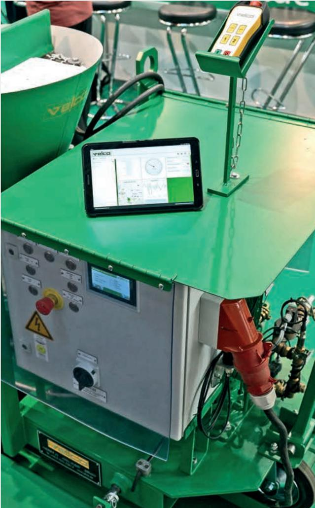
所有要求的解决方案。客户员工调出Velco云的操作面板，然后就可以看到导航窗口中列出的机器。谷歌地图视图中的地图指示各个机器的位置。若同事点击列表中的条目，则操作面板会提供所有相关数据的清晰概览。除了水压或物位等模拟值外，还包括数字化指标，例如运行状态或急停按钮的状态。用户还可看到运行小时数计时器以及其他数字显示。用户也可以自行设计操作面板，只需点击几下鼠标即可完成，无需任何编程知识。
