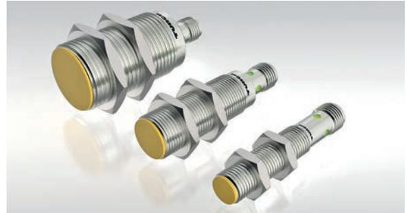
图尔克推出了带两路OSSD（输出开关信号设备）输出的电感式安全传感器，进一步完善了其安全技术产品组合。这些接近开关可使用户将非接触式（无磨损）位置和范围监测的优势应用于安全相关应用，包括压机、起重机、游乐场设施或机器外罩等。它们使用OSSD输出向安全系统发送开关信号，可同时检测短路、过载或交叉电路以及测试关闭能力等。凭借高达SIL 2 (IEC 61508) 和性能等级PL d (EN ISO 13849) 的安全等级，它们可满足功能安全方面的严苛要求。
