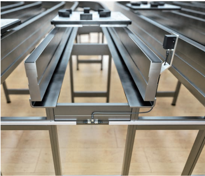
每个输送线都配有支持Bus Mode模式的读写头，它们可利用T型分线器轻松安装在线性拓扑结构中
