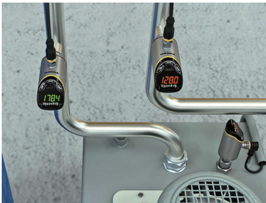
流体2.0系列传感器的安装尤其灵活，可以简化调试，这是因为传感器头部可在大约340°范围内自由旋转，且显示器可倒置以便悬挂安装
