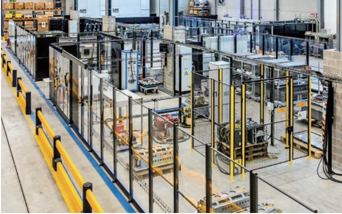
所有测试室入口通过图尔克的RFID解决方案保障安全，确保仅授权人员获准进入
