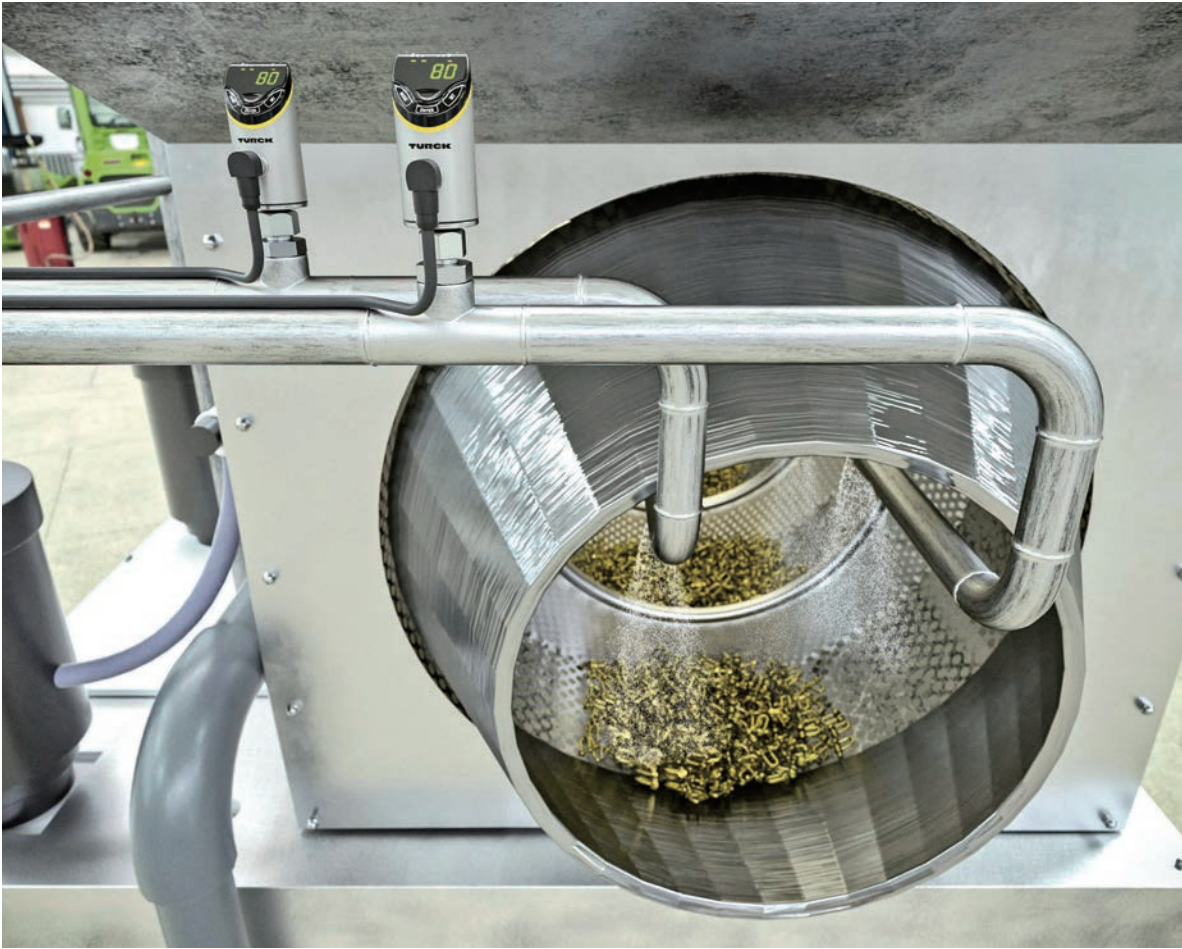
滚筒式清洗机示例： 强大的FS+流量传感器 监测液体介质的流量和 温度
