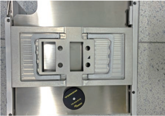
RFID载码体位于晶圆载具的顶部
