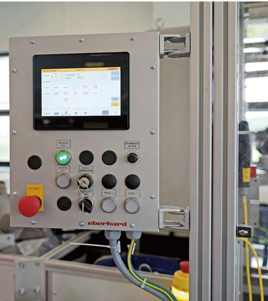
图尔克TX700系列HMI被用于可视化和云连接
