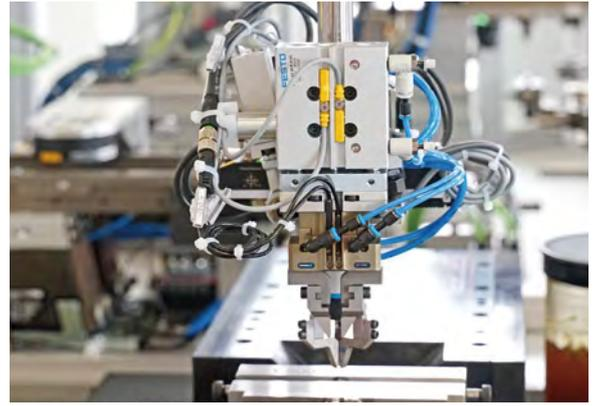
**BIM-UNTK** 磁场传感器通过检测活塞位置来检测夹钳的高度
