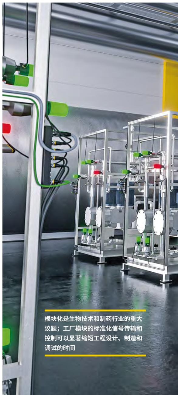
模块化是生物技术和制药行业的重大议题；工厂模块的标准化信号传输和控制可以显著缩短工程设计、制造和调试的时间
