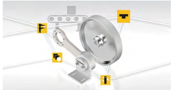
图尔克推出了能够可靠检测线性移动物体的弹簧臂和测量轮，进一步完善了其编码器产品组合。这些可自由组合的弹簧臂和测量轮系统可使传统的编码器能够测量长度和速度，从而轻松监测传送带的进度或速度。3款弹簧臂覆盖了各种需求：从价格敏感/节省空间到低维护/柔性弹簧臂，再到能够提供高接触压力的坚固型弹簧臂。所有弹簧臂型号都针对增量式和绝对式实心轴编码器进行开发。它们可与周长200 mm到500 mm的测量轮配套使用。
