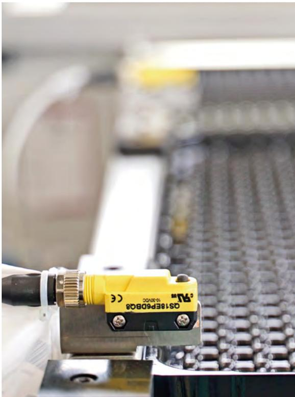
**QS18** 光电传感器检测放置成品连接器的托盘
