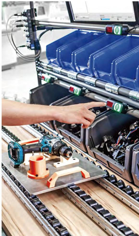
自动化、模块化的Smart Light Touch亮灯拣货系统具有非常独特的易安装特点，设置时甚至无需螺丝刀
