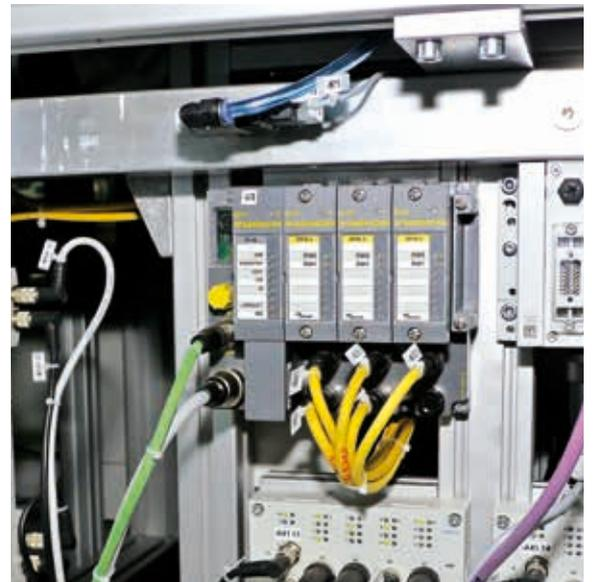
读/写头读取的数据通过带RFID模块的图尔克BL67网关传入数据库
