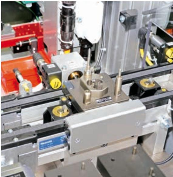
读头读取工件托架上的载码体数据以识别各个部件
