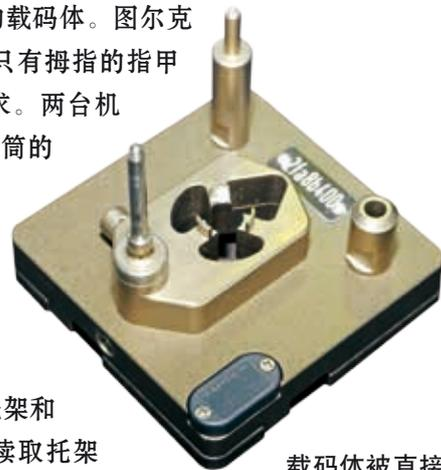
载码体被直接安装在铝制工件托架上
