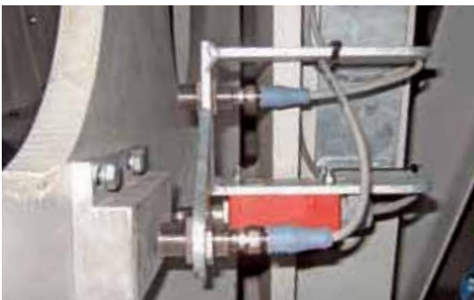
为确定当前扇叶角度，两台 uprox+ 传感器紧扣一种特殊的凸轮
