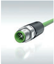
只有带M12连接器和8针脚的X编码以太网电缆支持1Gbit/s高速网络，且同样采用IP67组件
