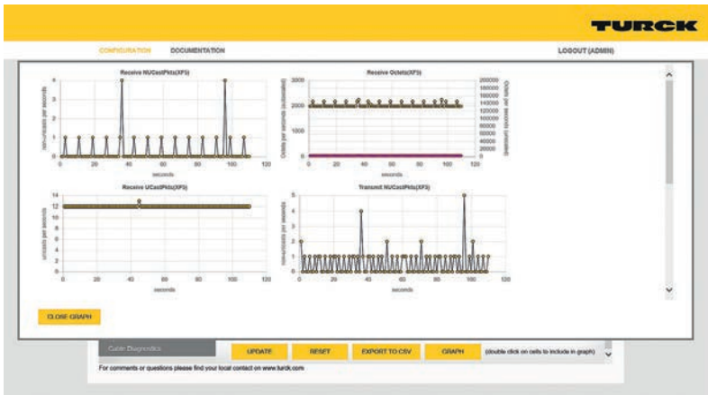
交换机的网络负载监控功能为用户 提供实时的以太网连接概览
