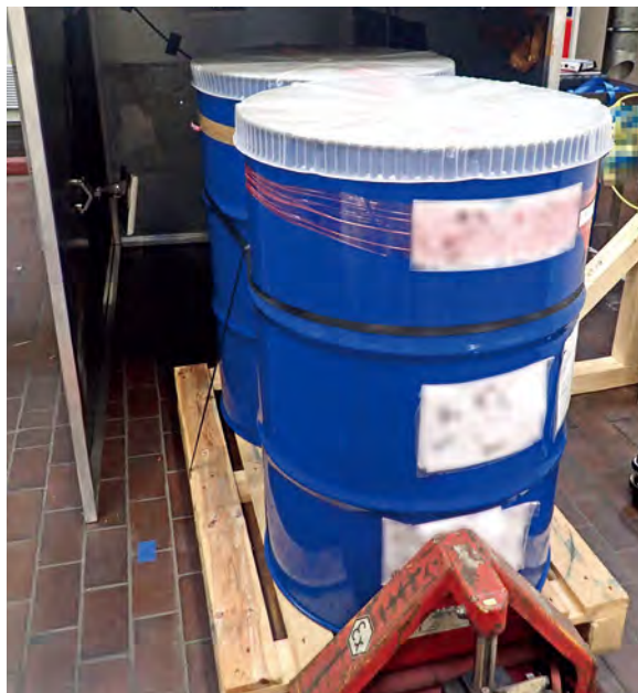
在该案例中，金属上的载码体使用桶本身作为扩展天线
