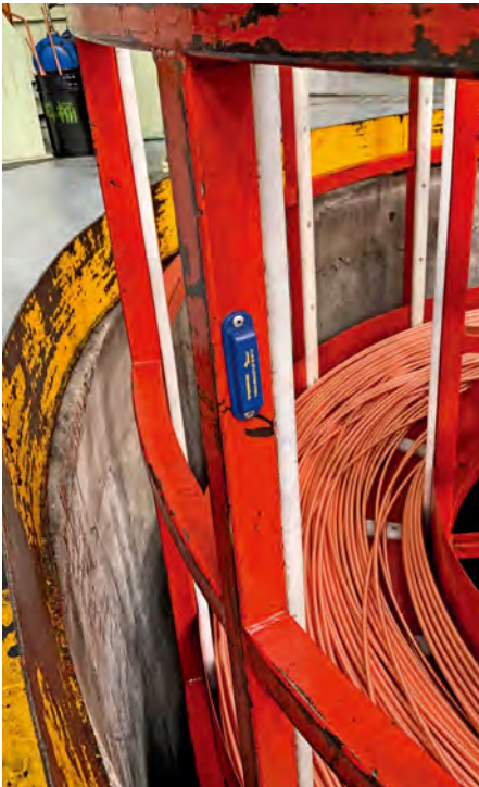
坚固外壳的UHF载码体可直接安装在金属料框上
