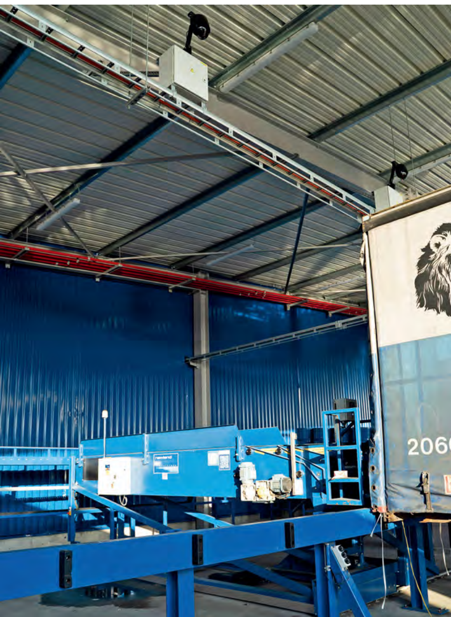
每个扫描仪监测一个停车区，从而确保快速装载并提升安全性
