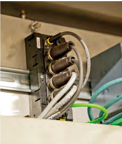
具有长检测距离的检验装置：当料盒通过NI10U-M12接近开关时，PLC启动针对收获作业的计时器
