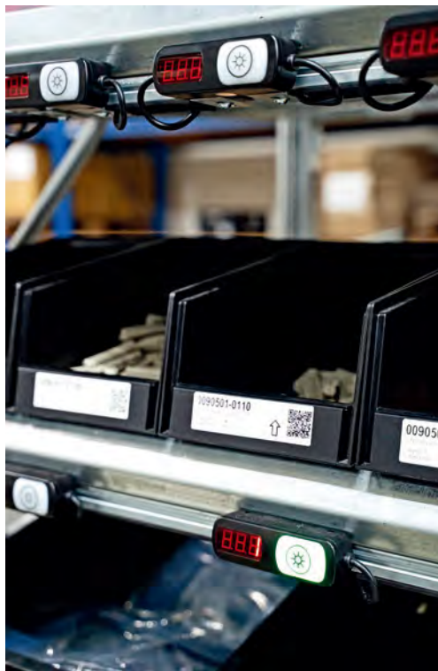
PTL装置在收集点通过光电检测技术运行，只需在下方移动脚即可进行确认
