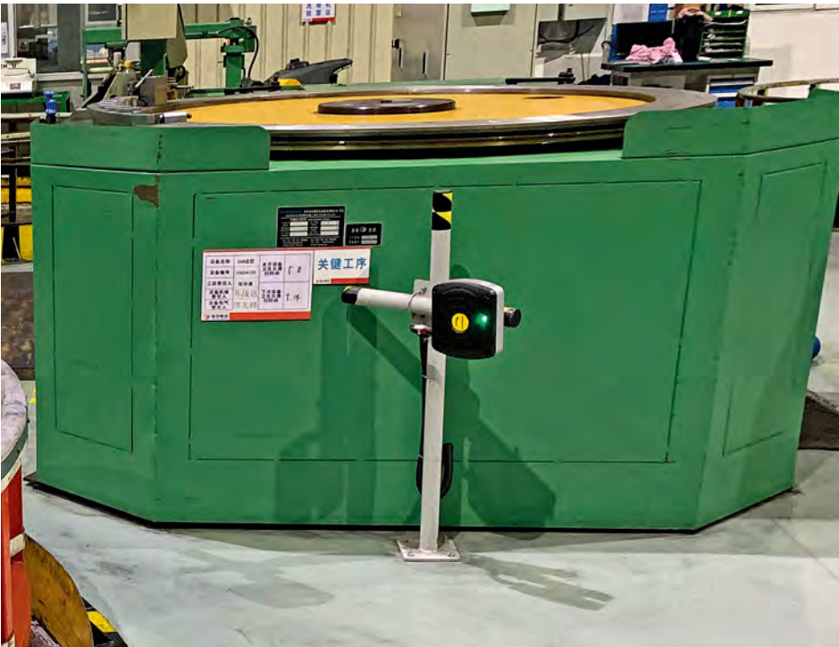
图尔克BL20 I/O系统中的可编程网关控制分布式RFID读写器 – 考虑到该公司具有大量的生产工作站，因此可实现非常大的优势
