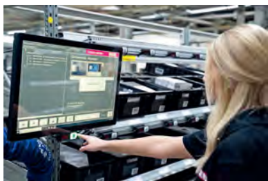
软件将图示说明显示到 屏幕上；操作通过电容 式触控按钮来确认
