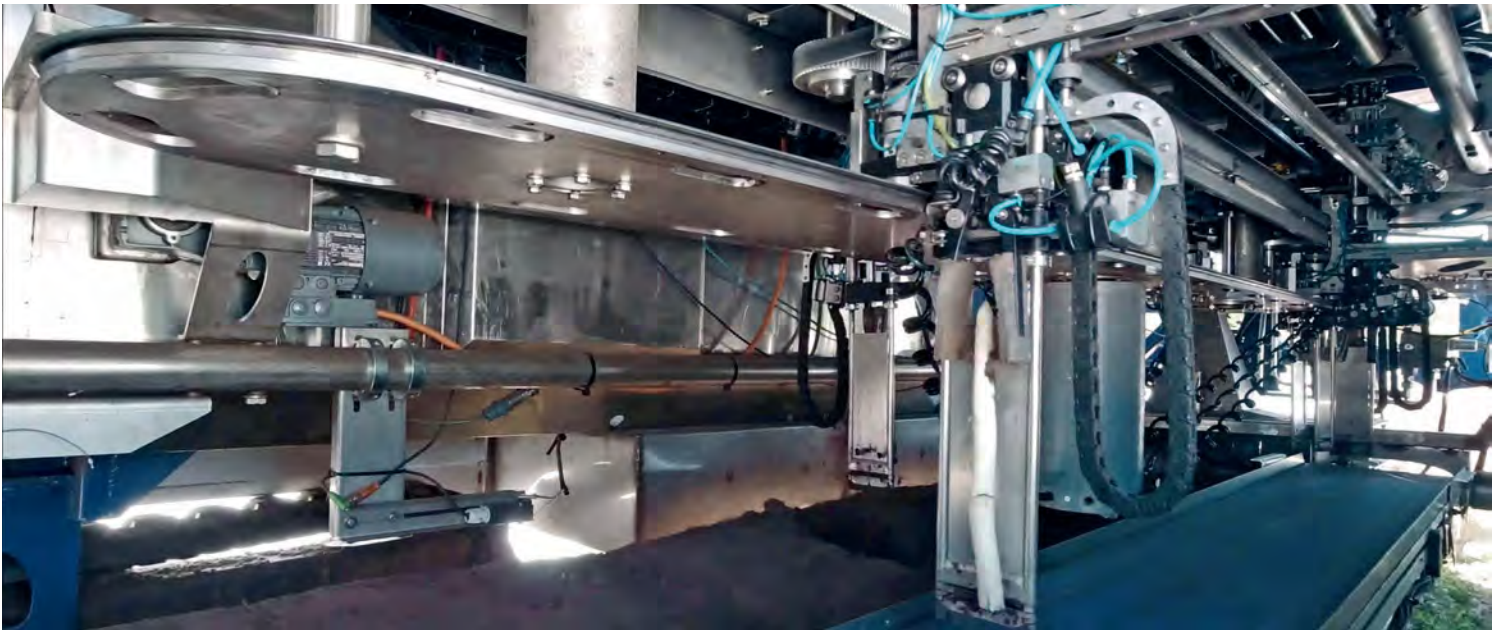
机器上布置了6到12个收获模块，控制器利用传感器的数据使这些模块运行到正确位置
