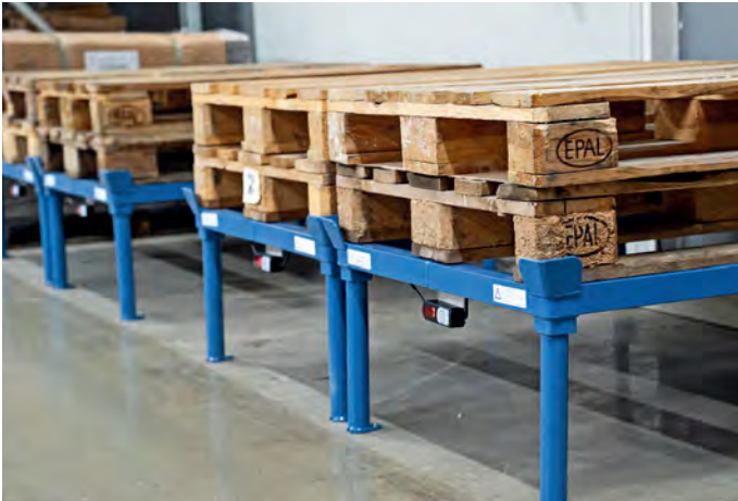
位于远程装载区的PTL110模块通过无线方式与整个系统相连
