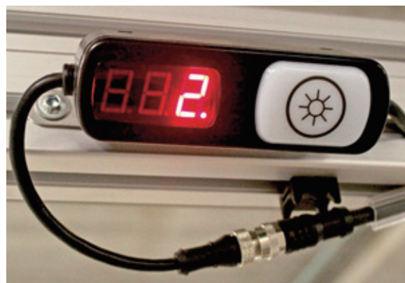
用途广泛的PTL110带有触控按钮、光电传感器和三位显示屏，尤其适合进行可靠的操作指导
