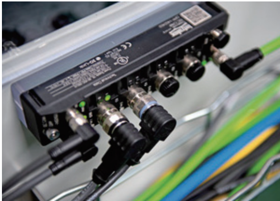
ISC CAM：图尔克坚固可靠的TBEN-S模块上的分布式Intralox逻辑实现了灵活多变的输送机布局，而无需复杂的控制柜安装
