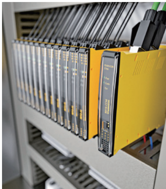
IM18-CCM通过以太网将测量值传输至IT网络，然后甚至可以对其进行远程预处理
