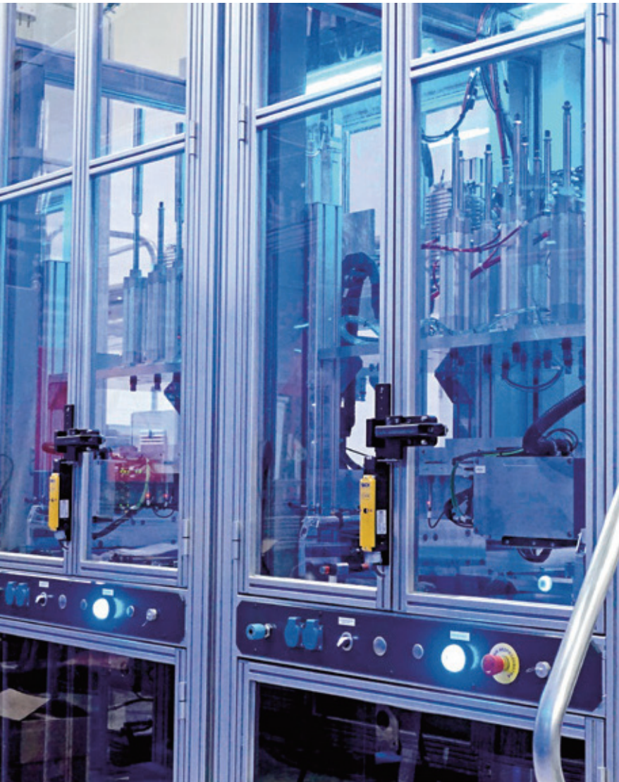
WLS27 LED照明灯通过不同颜色显示各个模块的状态
