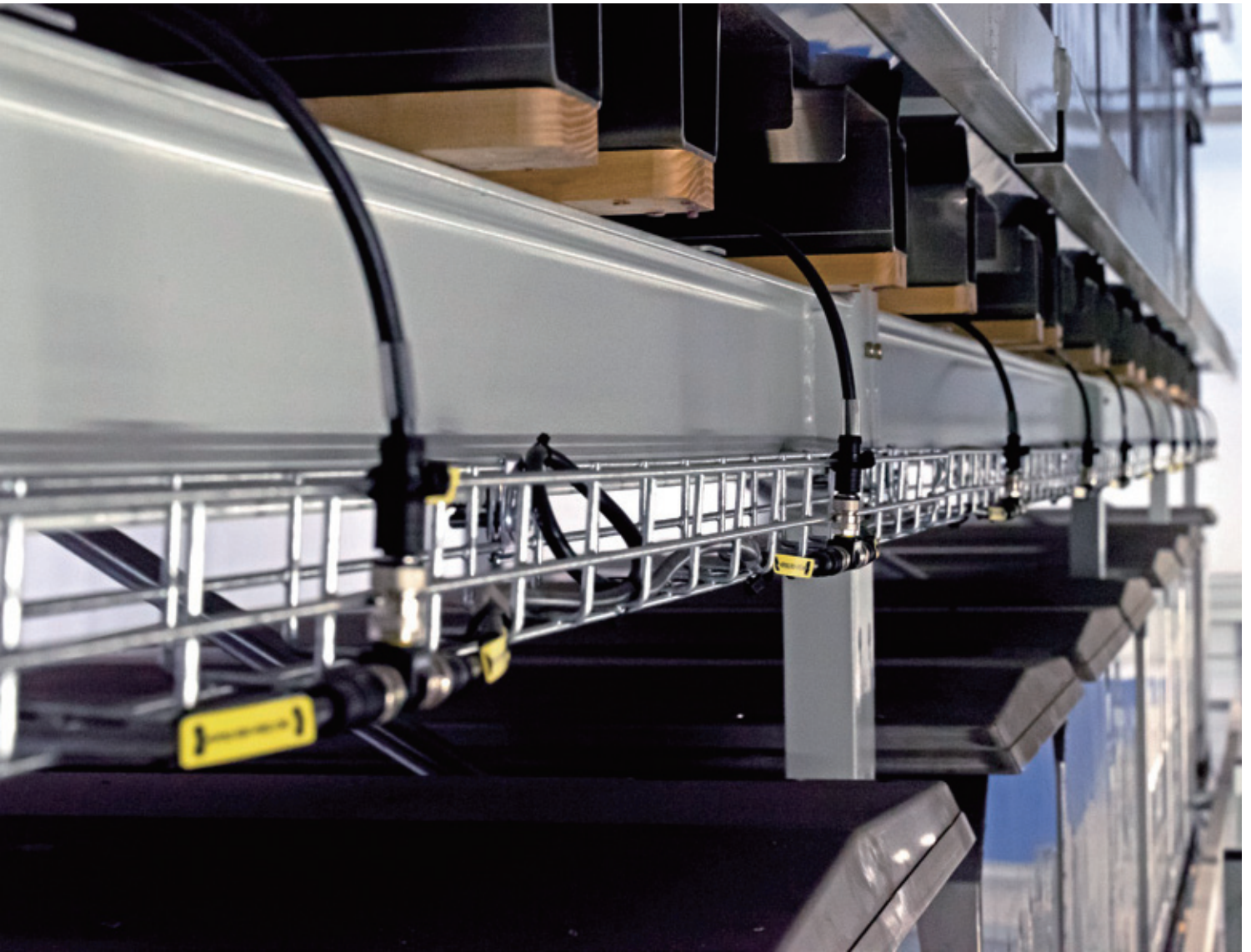
通过图尔克的高频Bus Mode模式，高频读写设备可以非常轻松地使用T型连接器连接到每个货架上，从而大大减少布线工作和成本
