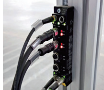
图尔克的TBEN-S多协议I/O模块确保PTL110与WMS之间的可靠通信
