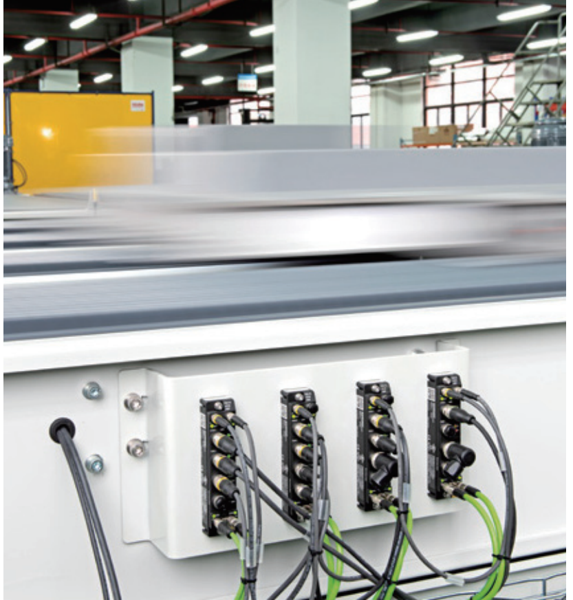
ISC CAM：图尔克坚固可靠的TBEN-S模块上的分布式Intralox逻辑实现了灵活多变的输送机布局，而无需复杂的控制柜安装
