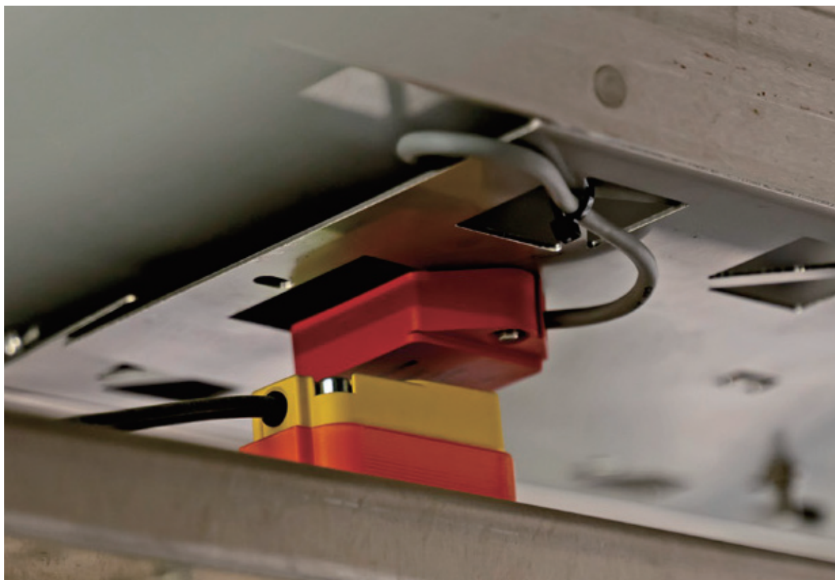
RFID载码体连接了一个传感器，用于测量存储容器内的温度
