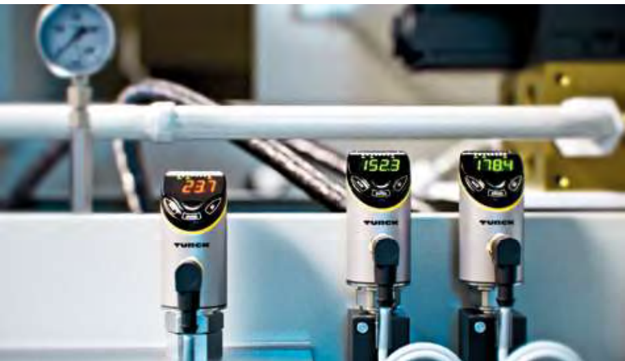
IO-Link流体传感器监测 电极压光过程中的辊压 和温度
