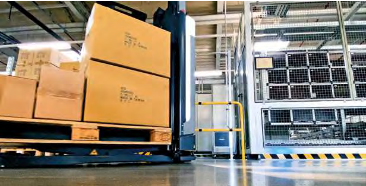
运输订单生成后，DTS在仓库库位拾取货盘
