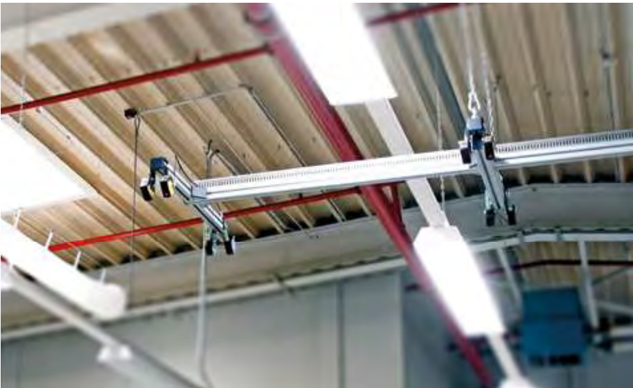
安装在三米高处的Q5X激光测距传感器可确定转运点是否有货盘
