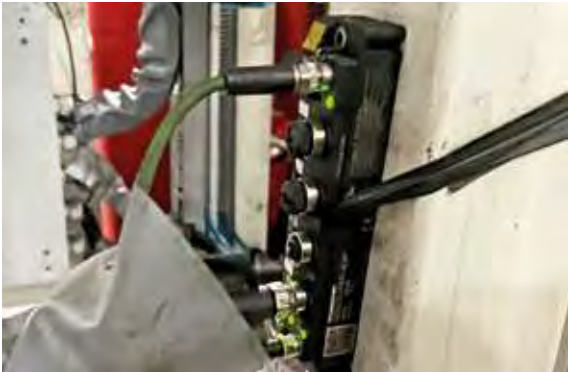
图尔克TBEN-S RFID模块具有1万6千字节的数据缓存区，性能惊人
