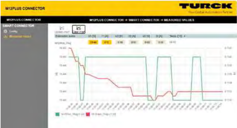
Turck Automation Suite以图形方式显示M12Plus的测量值
