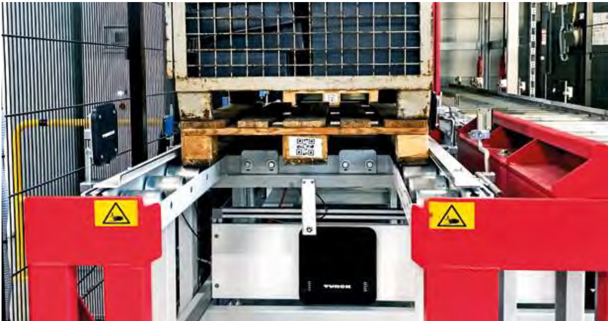
传送系统上的RFID外部近场天线只能检测到其正前方的货盘
