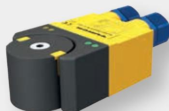
新型的RI-DSU35系列产品完全由TURCK自主研发，基于电感式谐振电路的测量原理，可用于测量旋转执行器和阀门的旋转角度，可提供模拟量输出，目前已经正式推出。藉由这种抗干扰式的测量原理，传感器可以更为精确地监控阀门和阀瓣的位置。不同于传统的阀位回讯传感器，新型的RI-DSU35系列产品可以在360度的角度范围之内任意调整测量范围。新产品的推出使得阀位测量装置的复杂调整以及重复调试成为了过去。
