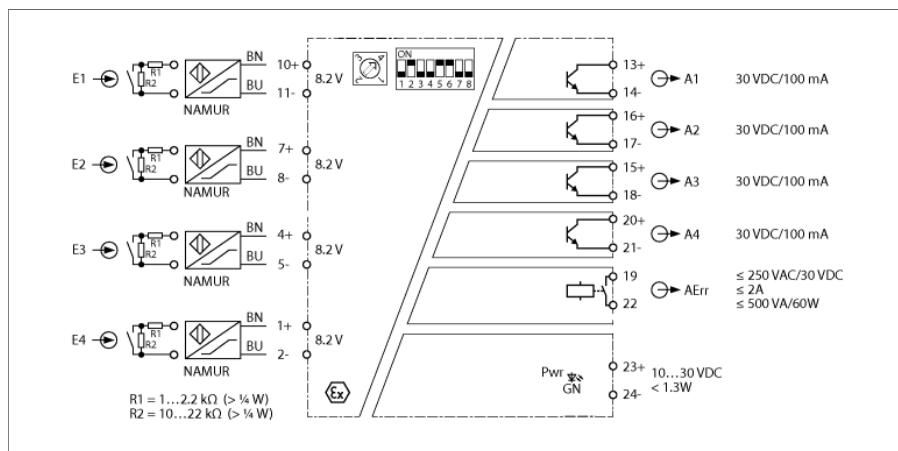
IMX18-DI03-... 隔离开关放大器配有多安型输入电路，可将二进制信号从有爆炸危险的区域传输到无爆炸危险的区域。可将符合EN 60947-5-6 (NAMUR)标准的传感器或无电位触点连接至该装置。该装置也适合在2类危险区域中工作。
