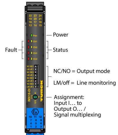
该装置带有绿色电源指示灯(Pwr)。每个通道都有一个用于指示输出的黄色状态灯和一个用于指示输入的红色状态灯。依据NE44，输入电路发生故障会导致红色指示灯闪烁。
