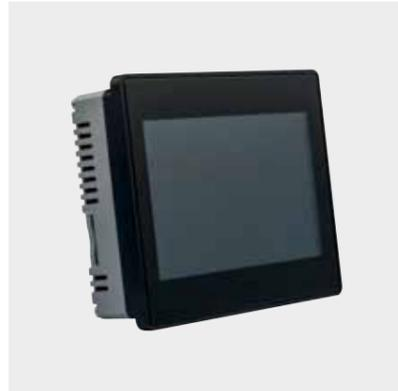
TX700系列HMI/PLC一体机采用创新型设计。高质量的金属外壳配备电容型玻璃触屏。屏幕的尺寸从5英寸到21英寸。TX700系列触摸屏有三个独立的以太网接口，可以适用于不同的应用。因此它可以作为一个通用的IOT平台来使用。通过VNC服务器可以方便的接入设备以进行远程的维护。PLC程序可以通过CODESYS V3进行自由的编写，可视化界面可以通过CODESYS自带的编辑器来实现或者使用TX VisuPro。
