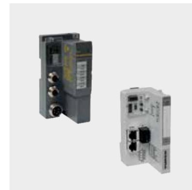
模块化I/O系统的BL20和BL67可编程网关新一代的BL20和BL67模块化I/O系统的可编程网关是通过CODESYS V3来进行的。多亏了图尔克多协议技术，可编程网关可运行在PROFINET、EtherNet I/P™和Modbus TCP这个三个协议中的任意一个。作为一个智能从站，可编程网关可以在本地对数据进行预处理，自动运行程序或者作为一个协议转换器来使用。
