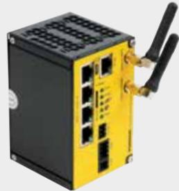
TCG20边缘计算网关能提供许多接口来简单的集成到自动化网络中。这样做的好处就是老系统和新系统的控制器都能够简单快速的集成到云系统中。由于TCG20具有基于web技术的边缘PLC,且有图形编辑功能，这样通讯数据就能为TCG20进行准备或者预处理，而不需要其他额外的硬件和软件。
