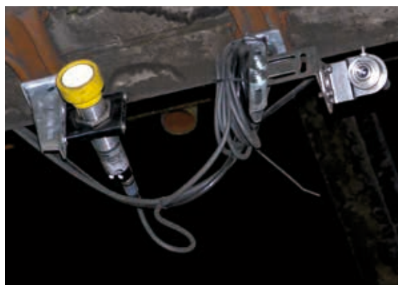
超声波传感器触发红外传感器（左）测量温度
