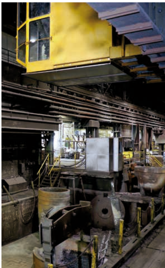
控制轿厢（右上）中的起重机驾驶员可观测到所有相关钢包的温度
