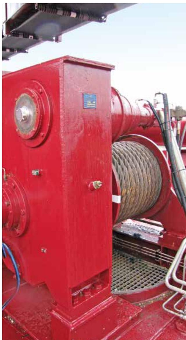
当中的三个卷扬机用于引导吸管（左上），而编码器则负责检测卷扬机卷轴的旋转运动。
