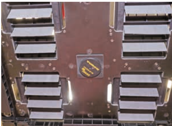
工件载具的仰视图显示了中心安装的标签和四个带风门片的后排气孔
