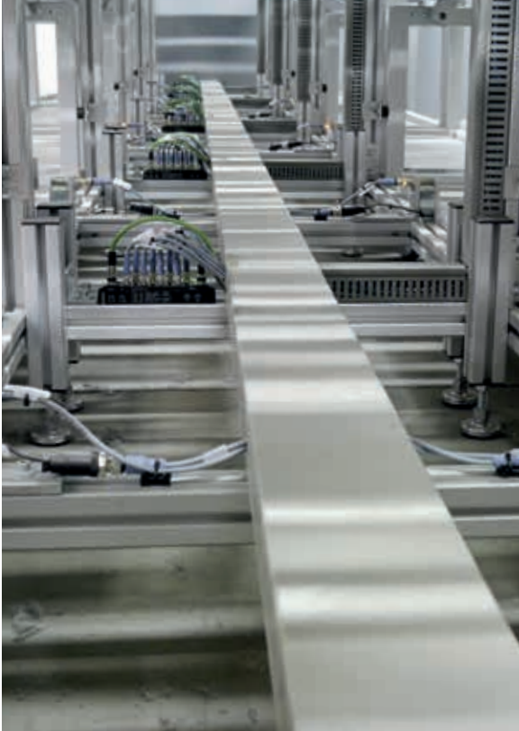
5个堆叠器模块中的每一个都配备了TBEN-S，它可以连接传感器的输入和输出信号
