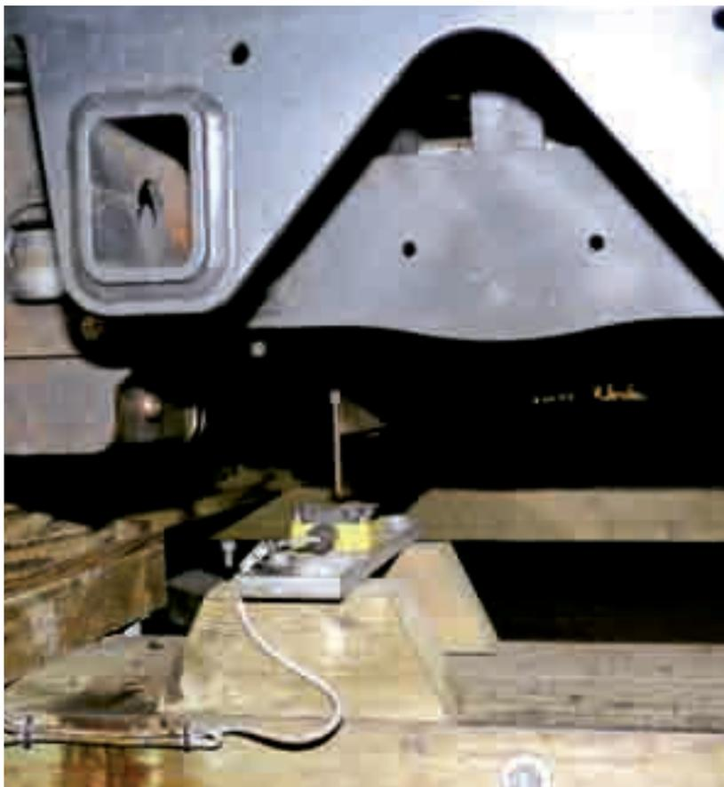
过山车下方的视图显示了：坚固uprox+传感器上方Wodan木质过山车的铜质制动翼
