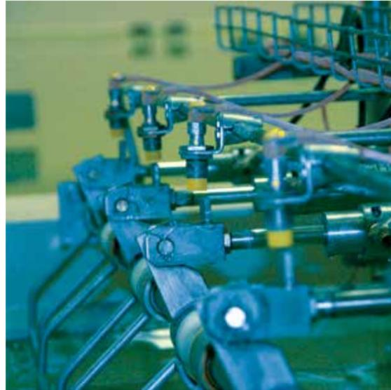
TURCK 公司通用型电感式传感器，在外形不变的情况下具有更长的检测距离，通用性更强，满足客户对极限位置的检测。
