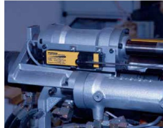
TURCK公司新型的外置式电感式直线位移传感器是基于全新的、革命性的测量原理生产出来的。综合了标准测量系统的良好特点，并且得到了进一步的发展。新型直线位移传感器的测量原理是基于RLC耦合产生的，是电感式原理的革新技术。不像电位计式或磁致伸缩式传感器的检测原理，这种测量方式具有相当大的优势。
