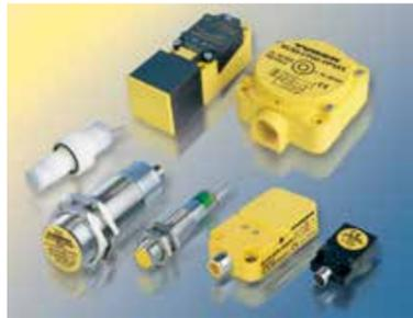
**TURCK 电容式传感器**能够检测常规电感式和光电式传感器不能检测物体。它能以非接触方式检测木材、玻璃、纸板、塑料、混凝土块、胶水、细金属丝、硅晶片，还能够透过透明玻璃或塑料来检测液位和其它非金属材料。可嵌入传感器特别适合齐平安装于金属中。它还具有晶体管输出，高开关频率，且无移动部件。TURCK 电容式传感器可提供 DC、AC 和本安型版本。
