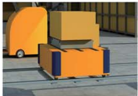
③ AGV小车上方的读写头通过读取托盘上的载码体进行物料识别；电感式传感器对小车的举升装置到位情况（零点，上限位，下限位）进行检测；增量型编码器用于速度测量（检测驱动电机转速），绝对型编码器用于转向控制（检测转向角度）
