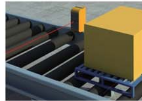
⑥ 直反式光电开关判断货物是否通过指定位置
