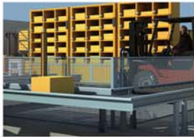
⑤ 电感式传感器监控托盘到位，如托盘占用、备用情况等，以及分拣系统的机械到位，如旋转、分轨等
