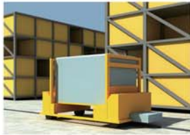
④ 安装于AGV上的读写头，通过读取地面上的载码体进行地标识别
