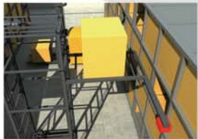
② 电感式传感器监测货叉/伸缩叉伸缩方向及起升到位置情况，水平行走到位情况；编码器可分别安装于电机尾端和提升电机尾端，监测堆垛机水平行走位移和起升位置
