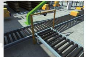
⑩ 通过视觉传感器读取货物的条码信息，进行分拣处理
