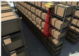
⑭ 通过光电开关，判断货物是否安放到指定位置，有无突出货架
