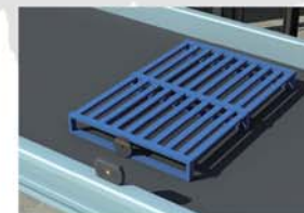
⑪ RFID通过读取托盘上的标签，获得托盘存储信息，进行货物跟踪及追溯
