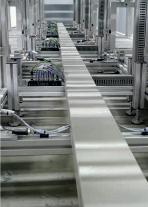
5个堆叠器模块中的每一个都配备了TBEN-S，它可以连接传感器及执行器的输入和输出信号
