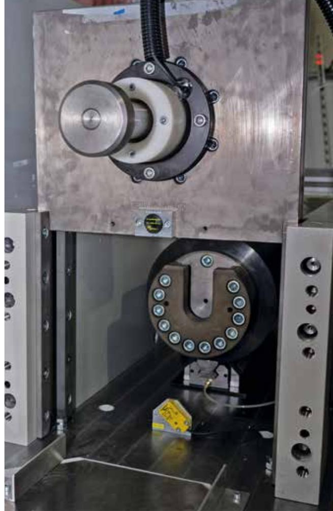
如果模具顶部的TW-R30标签被安装在金属中，也能够被可靠地读取
