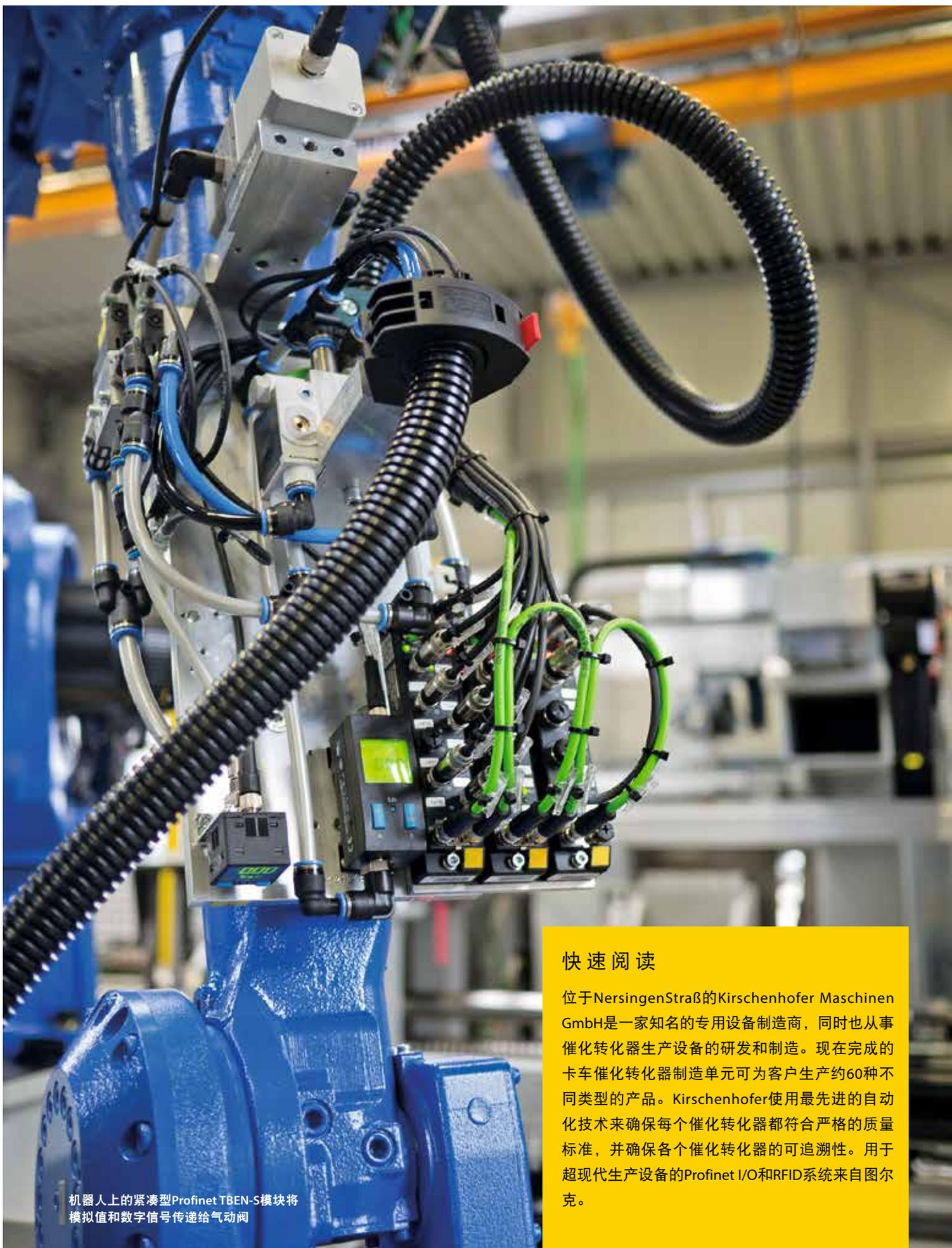
机器人上的紧凑型Profinet TBEN-S模块将模拟值和数字信号传递给气动阀
