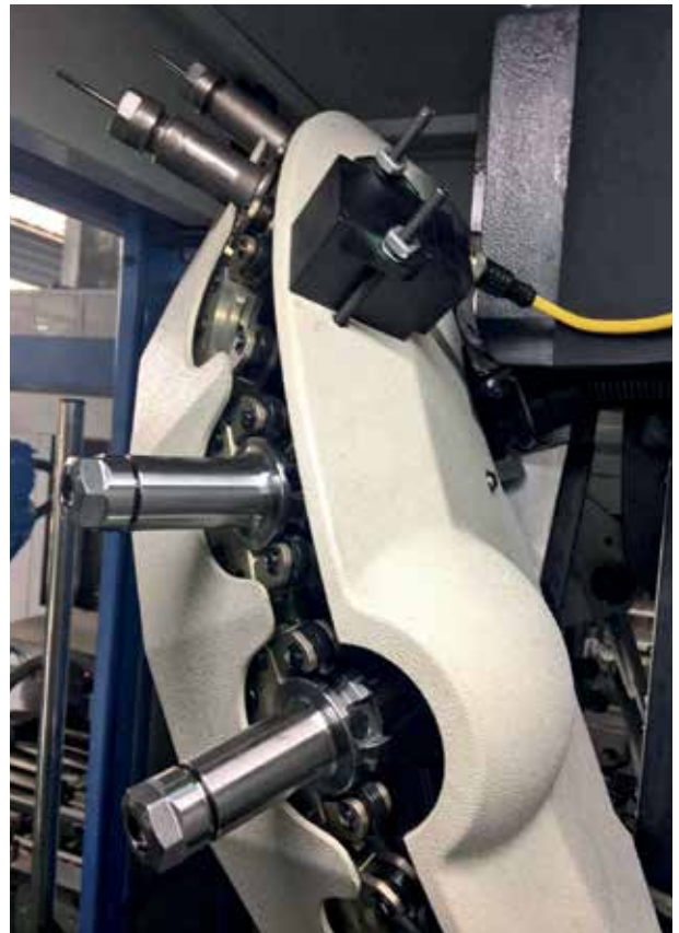
RFID读写头安装在刀盘的背面，超长的感应距离，透过背板可以可靠地检测刀柄上的标签
