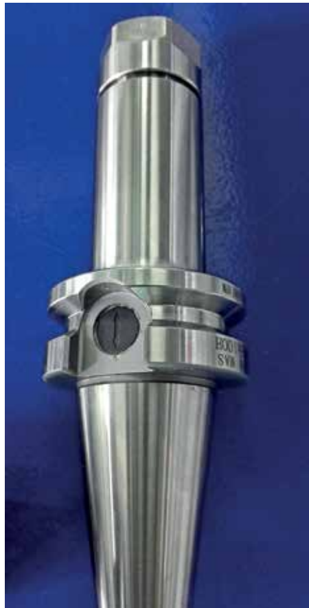
带有嵌入式RFID标签的刀柄
