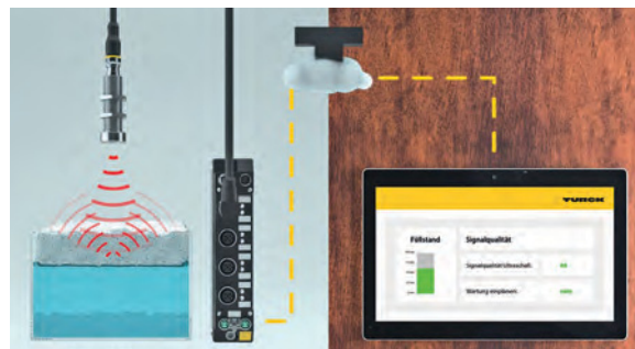
除了提供液位值外，超声波传感器还可指示物体表面泡沫的堆积情况
