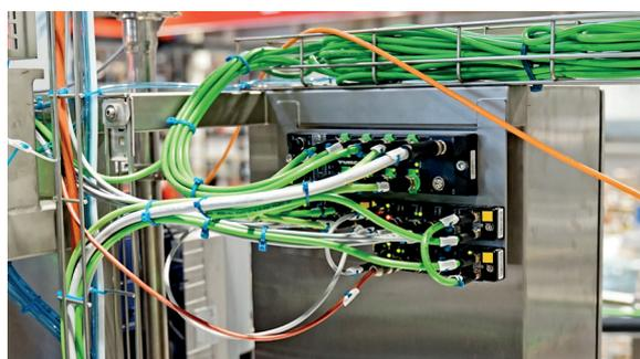
图尔克的TBEN-LL-SE-M2以太网交换机 (如图) 具有八个 100 Mbit 和两个Gbit端口，可实现快速、安全的机器内数据传输。
