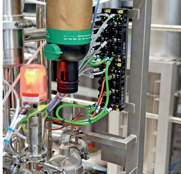
TBEN-S2系列的I/O模块宽度仅为32毫米，可灵活安装到各个位置。
