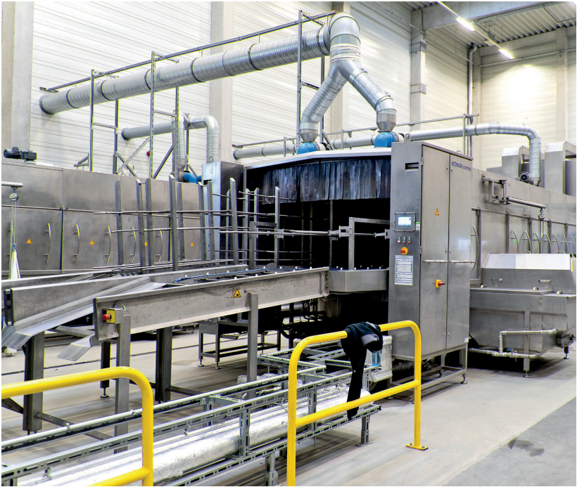
周转载具在清洗系统中自动清洗
