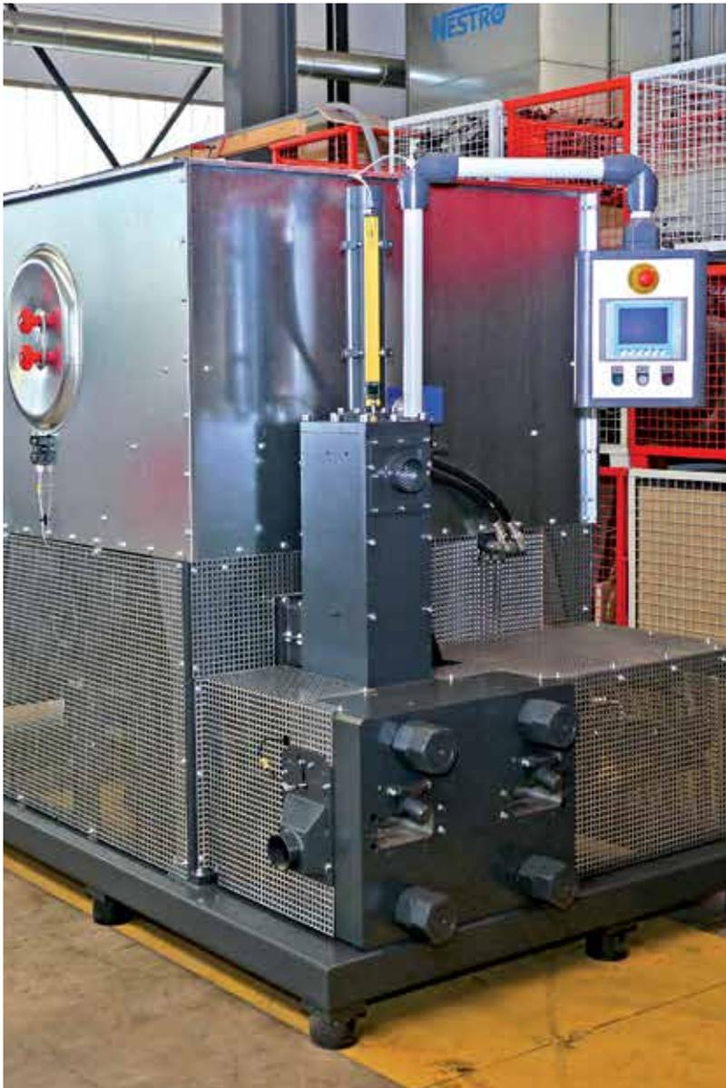
Weima的紧凑型压块机已经使用Li传感器多年 - 其中包含测量长度达2米的型号
