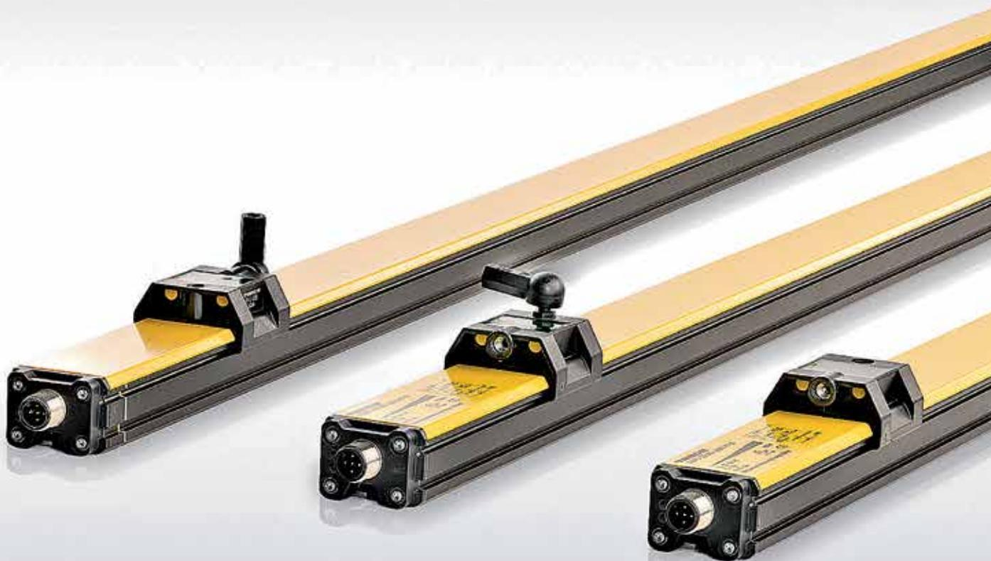
电位计和磁致伸缩测量原理是使用十分广泛的系统。与其他原理一样，这两种原理也有其优缺点。电位计不采用非接触式原理操作。为了尽可能减少磨损，需要测量系统与移动装置之间具有无负载和无间隙的耦合。移动装置压力过大或冲击过多都会显著加重电位计内游标的磨损。因此，该系统的安装需要尤其小心。若装置内有灰尘或凝露，导体上滑动触点的机械耦合同样是个问题。当传感器密封件老化，该问题的发生概率就越大，从而影响测量。操作人员通常不会注意到传感器特性的变化。
