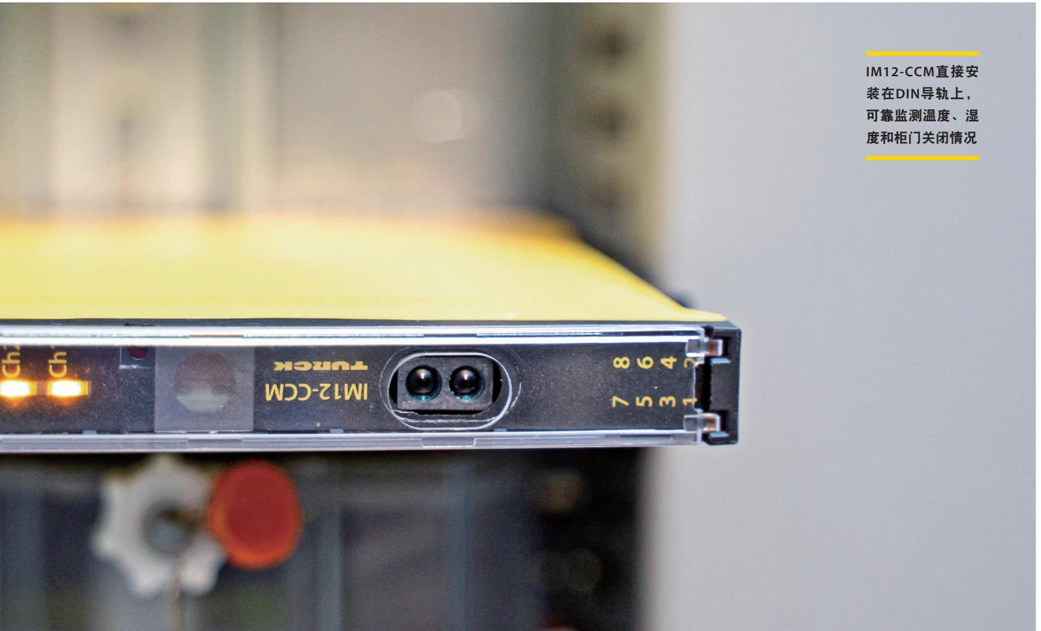
IM12-CCM直接安装在DIN导轨上，可靠监测温度、湿度和柜门关闭情况
